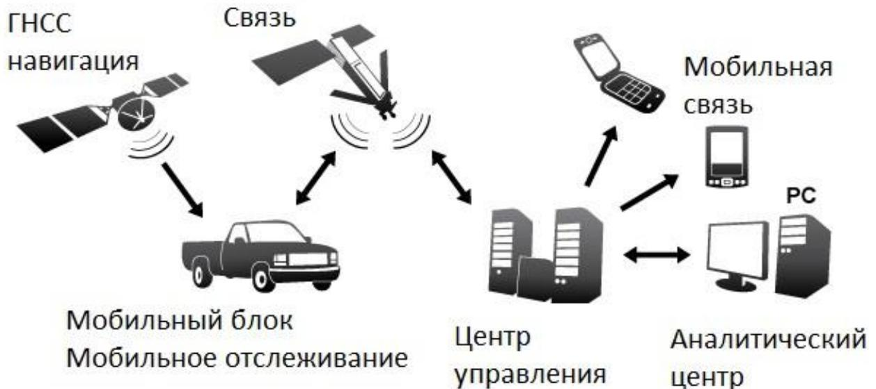
**Рис. 4.** Спутниковая схема управления автодорожным транспортом
