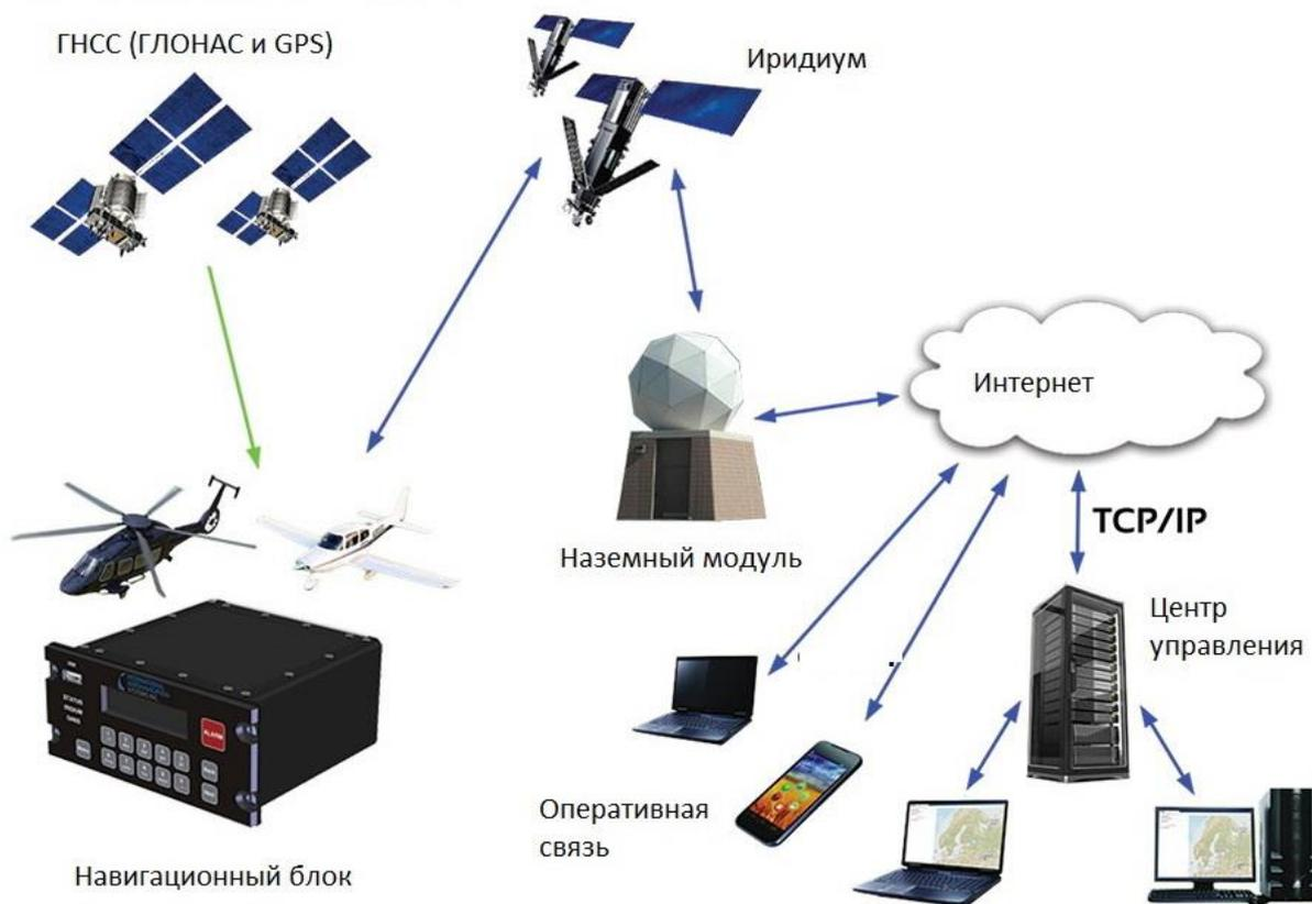
**Рис. 3.** Спутниковая схема управления воздушным транспортом.
