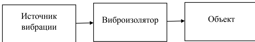
Рис. 1. Общее устройство работы виброизоляции
